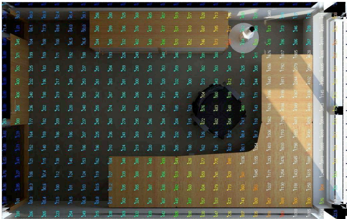
Figura 9.2.7: Iluminación natural de un espacio de oficinas. Los LUX calculados se representan numéricamente.
